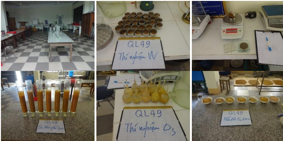
Hình 8. Một số hình ảnh thí nghiệm tính chất vật lý mẫu đất
