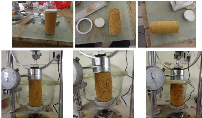
Hình 11. Một số hình ảnh chế bị mẫu và thí nghiệm UC
