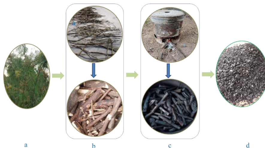
Hình 1. Quá trình sản xuất biochar
