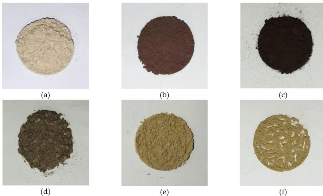
Hình 1. Hình ảnh của bột nguyên liệu (a) và các mẫu vật liệu nung ở các nhiệt độ 250 (b), 300 (c), 400 (d), 500 (e) và 600 °C (f)
